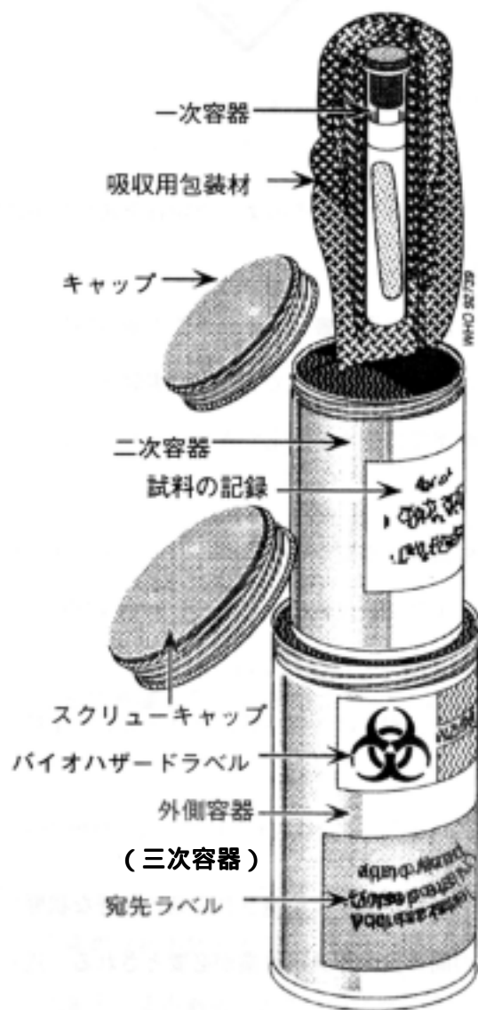
図2 (参考) WHO, Laboratory Biosafety Manual 2nd edition に示されている、郵送のための包装法
